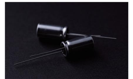
Crystal Epシリーズで導入された特殊アルミ電解コンデンサを6基搭載。内部導体には帯状に加工された高純度アルミニウム箔を使用。導体表面を特殊エッチング処理することで、空洞が無数に形成され、導体表面積の拡大をもたらす。これにより1基あたり11,000cm<sup>2</sup>(110cm×100cm)という広大な有効面積を確保
