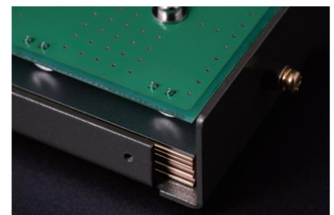
「Crystal E-G」のレイヤー構造。内部の異金属プレート構成は「Crystal E」や「Crystal E Jtune」と同様。各プレートの加工処理によって違いがあり、「Jチューン」はサンドブラスト加工、「E-G」はさらに高精度化させたファインブラスト加工を採用。面積の拡大とともに表面凹凸形状を均一にコントロールし、表面積のパラツキを低減している
